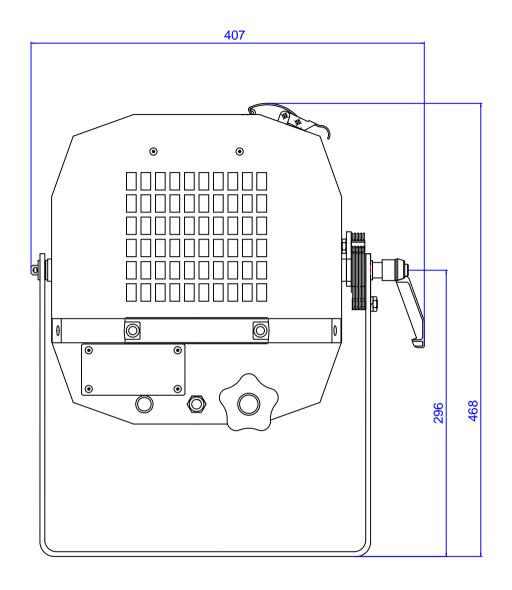
Halogen-Stufenlinsenscheinwerfer AVP 201 NW/AVP 2501 NW/AVP 201 NWK Bei Bedarf: Zeichnung im DXF-Format bitte anfordern
